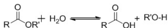
Imatge 18: Hidròlisi d'un èster per a obtenir un àcid gras, on R és la cadena de l'àcid i R' la cadena de la glicerina.
