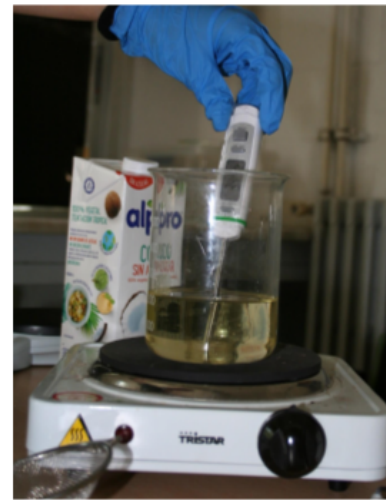
Imatge 76: Pas 2: Escalfament de l'oli. Font pròpia.
