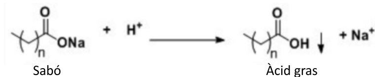
Imatge 53: Formació d'àcid gras a través de sabó i un d'hidrogen procedent de l'aigua àcida.
