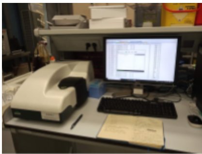
Imatge 1. Zetasizer Nano ZS amb ordinador al costat
