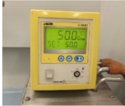
Imatge 8. Bomba per escalfar reactor
